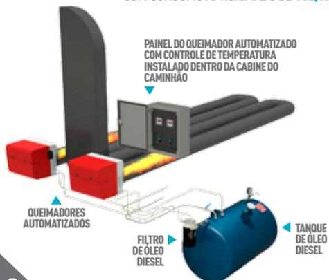
PAINEL DO QUEIMADOR AUTOMATIZADO COM CONTROLE DE TEMPERATURA INSTALADO DENTRO DA CABINE DO CAMINHÃO
